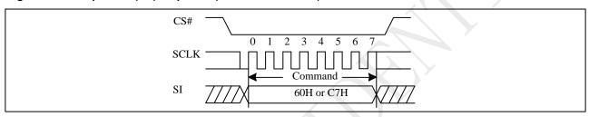
Figure 10-32a Chip Erase (CE) Sequence (QPI)
